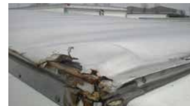
↻ Dachfläche: Rahmen beschädigt, Leder kann nicht auf wirtschaftliche Weise repariert werden
