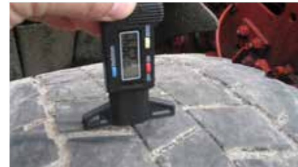
Reifen: Reifenverschleißanzeige > 3 mm, abgetragen
