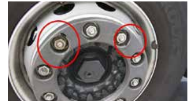
Radabdeckungen: Verformt, gebrochen, Material fehlt oder entfernt
