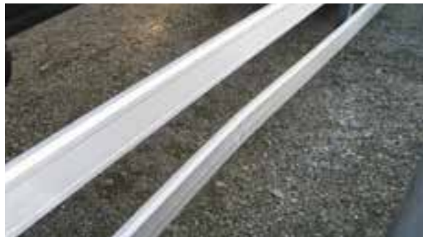
✂ Seitenunterfahrerschutz: Verformungen, die auf wirtschaftliche Weise repariert werden können
