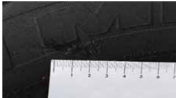
Reifen: Reifenverschleißanzeige \leq 3 mm (ERFÜLLT)
