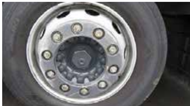
Felgen und Radabdeckungen: Mehrere oberflächliche Kratzer mit oder ohne Materialabtrag
