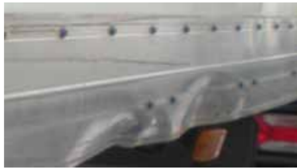
↻ Unterboden-Seitenprofile: Verformungen, die nicht auf wirtschaftliche Weise repariert werden können, Durchdringungen, fehlende Profilabschnitte
