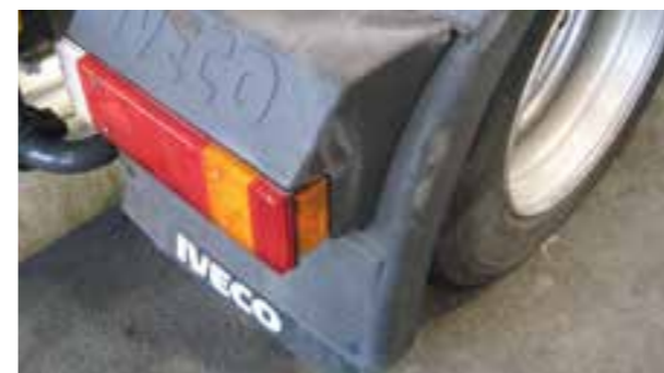
Tiefe Kratzer und Verformungen
