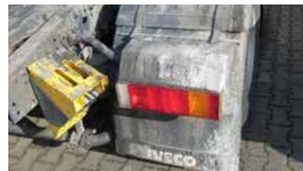
Starke Verfärbung durch chemische Elemente
