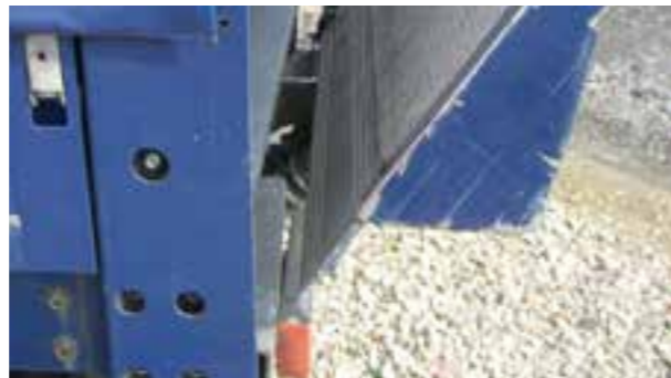
✂ Ladebordwand: Verformungen der Plattform, die auf wirtschaftliche Weise repariert werden können
